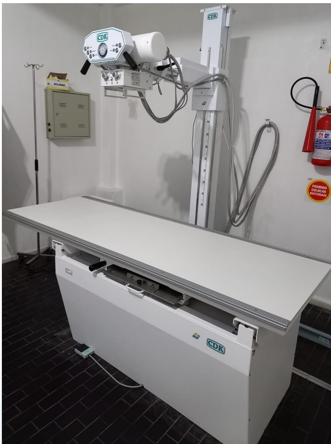
Mesa Bucky de Exames - DIAFIX – Raio – X – Fixo, Diafix Dinamic, alocado na sala de Raio-X.
