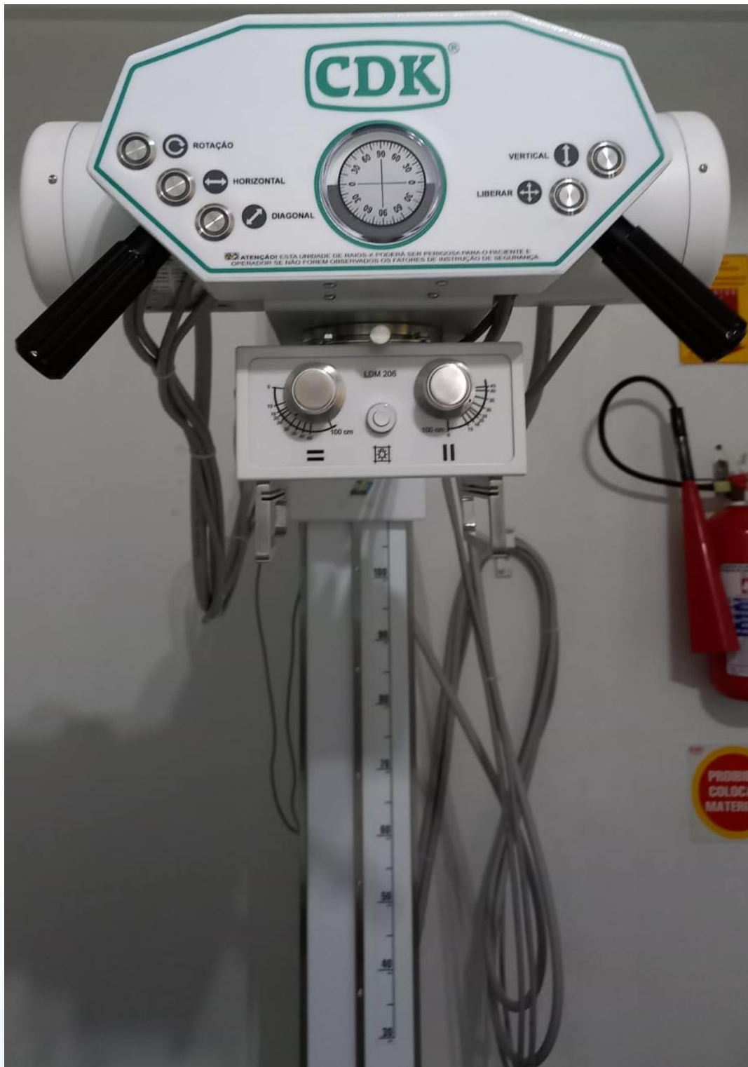
Colimador Luminoso - DIAFIX – Raio – X – Fixo, Diafix Dinamic , alocado na sala de Raio-X.
